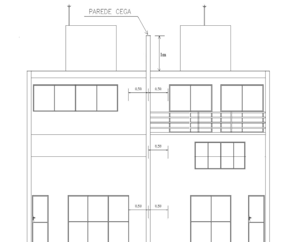
Figura 1 - Distanciamentos e projeção obrigatórios da parede cega.
