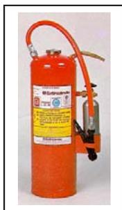
Extintores portáteis de pó químico a pressurizar são providos de uma tampa de alumínio fundido e dotados de válvula de alívio. Sua pressurização é efetuada através de um cilindro contendo 80g de CO<sub>2</sub>. Válvula de pressurização do tipo abertura lenta, construída em latão forjado e dimensionada para funcionar a 18kgf/cm<sup>2</sup> provida de disco de segurança em bronze fosforoso, e seguindo as demais especificações do item anterior.
